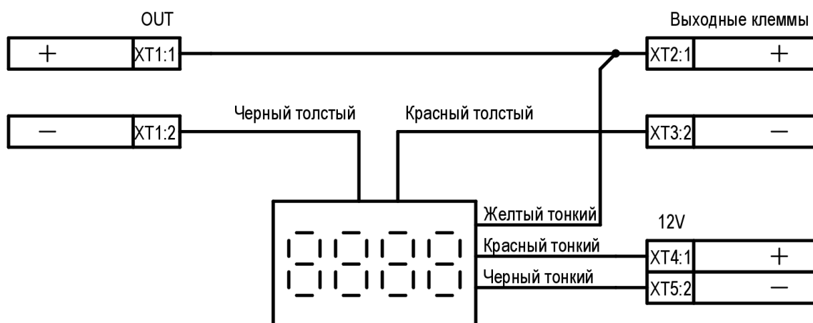
Рисунок 2 - схема подключения вольтметра-амперметра
